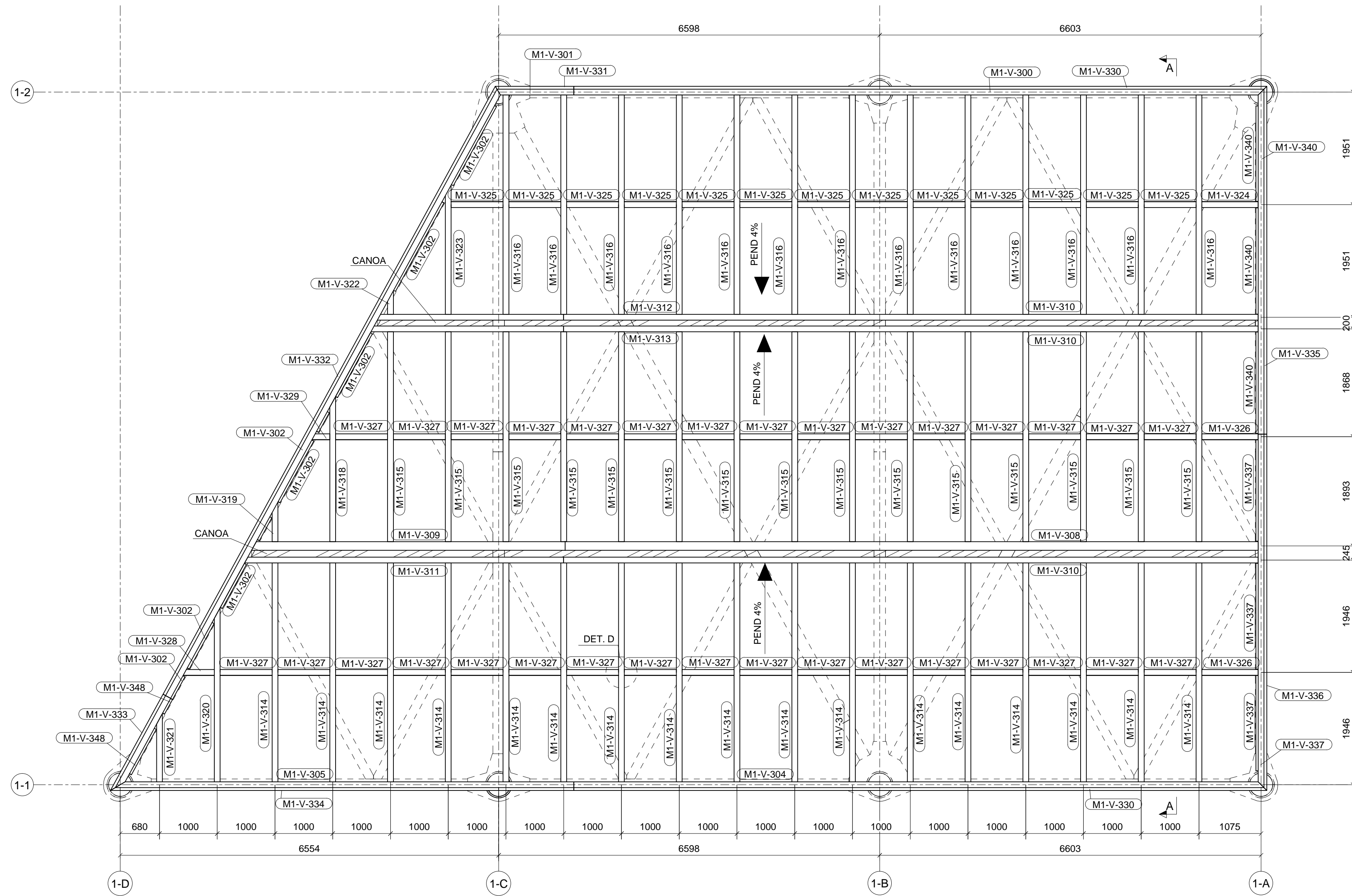
PLANTA ESTRUCTURA SOPORTE DE VIDRIO ESC: 1:50
